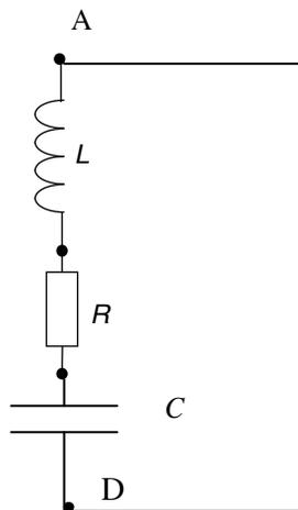
On alimente le circuit (entre A et D) par une tension sinusoïdale  $u(t)$  de valeur efficace  $U_e$  et de fréquence  $f$ .
