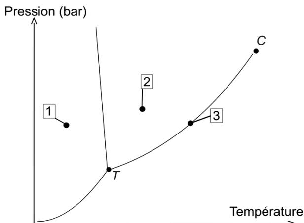
• Diagramme ( $P, T$ ) de l'eau pour l'équilibre liquide/vapeur entre  $100 \text{ °C}$  et  $200 \text{ °C}$  (extrait)
